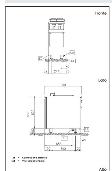
**Elettrico** Tensione di alimentazione: 400 V/3N ph/50/60 Hz Watt totali: 12 kW Informazioni chiave Numero vasche: 2 Dimensioni utili vasca (larghezza): 140 mm Dimensioni utili vasca (altezza): 230 mm Dimensioni utili vasca (profondità): 345 mm Capacità vasca: 4 lt MIN; 5 lt MAX Controllo termostatico: 100 °C MIN; 180 °C MAX Dimensioni esterne, larghezza: 400 mm Dimensioni esterne, profondità: 900 mm 800 mm Dimensioni esterne, altezza: Peso netto: 65 kg
